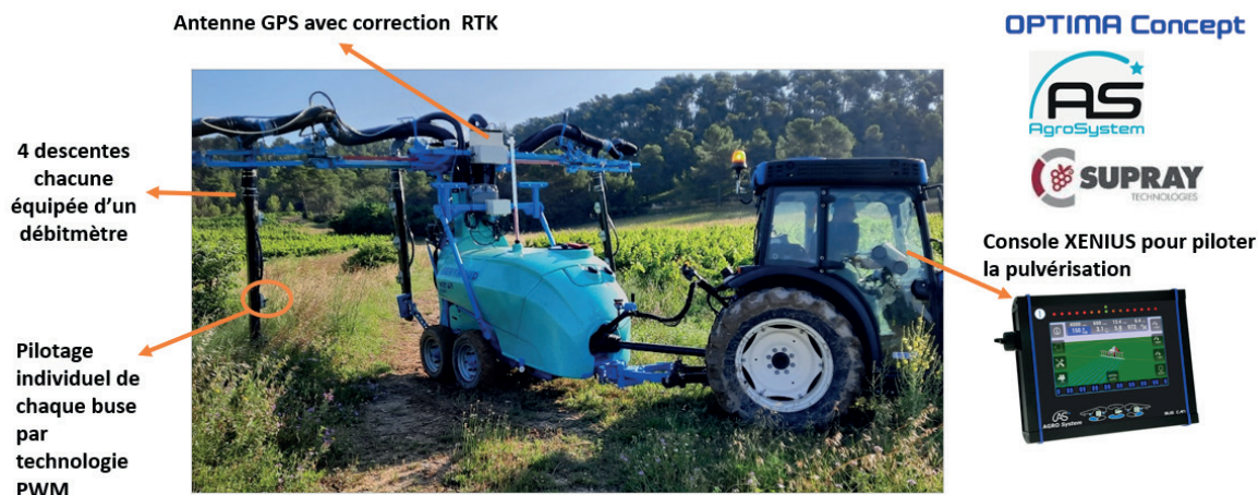
FIGURE 1. Prototype de pulvérisateur basé sur la technologie de contrôle des buses PWM (dispositif SRP (Smart Regulation Pressure)). Crédit Photo IFV.
