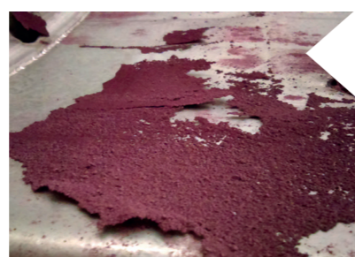
Photo 1d Encrassement par entartrage. (Crédit photo IFV)
