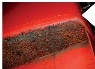
Photo 1a Encrassement par corrosion. (Crédit photo IFV)
