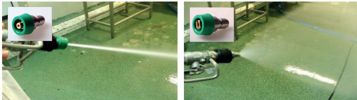
Photo 11 consistance de la mousse et choix de la buse pour l'utilisation du canon à mousse (CTCPA). (Crédit photo IFV)
