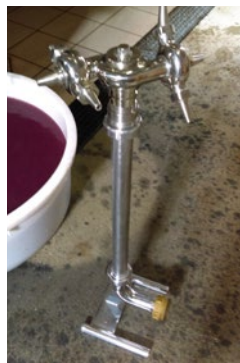
Photos 3 Le jet rotatif assure, lors d'un nettoyage de fin de fermentation, un accès du détartrant, détergent ou désinfectant à un maximum de surface dans les meilleures conditions. IFV Amboise, 2019
