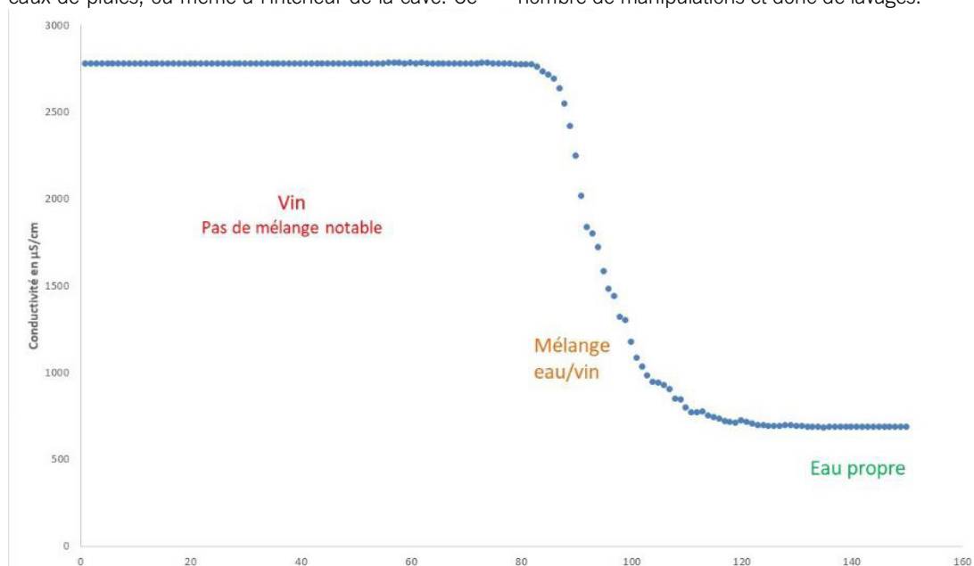
Figure : Cinétique du rinçage lors d'une pousse à l'eau
