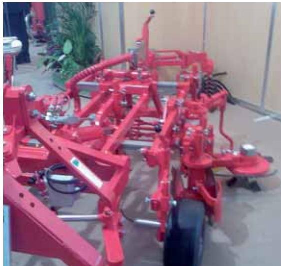
Châssis Boisselet à recentrage automatique
