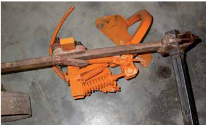
Lame sarcluse Humus Hugg avec dispositif d'effacement mécanique
