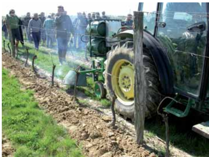
Désherbage thermique Souslikoff
