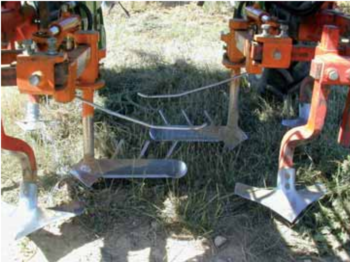
Lames intercep Braun sur châssis enjambeur
