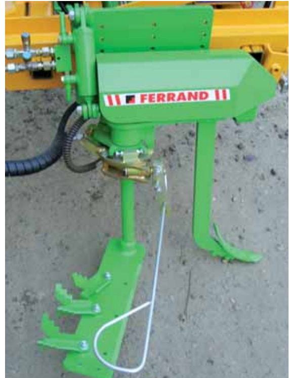
Lame intercep Ferrand avec ailettes de fragmentation et contrôle dévers
