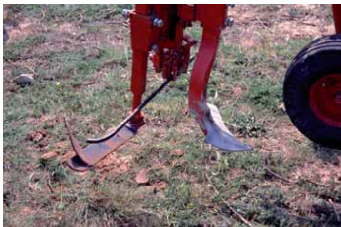
Cutmatic Boisselet avec coutre à l'avant pour faciliter le travail de la lame
