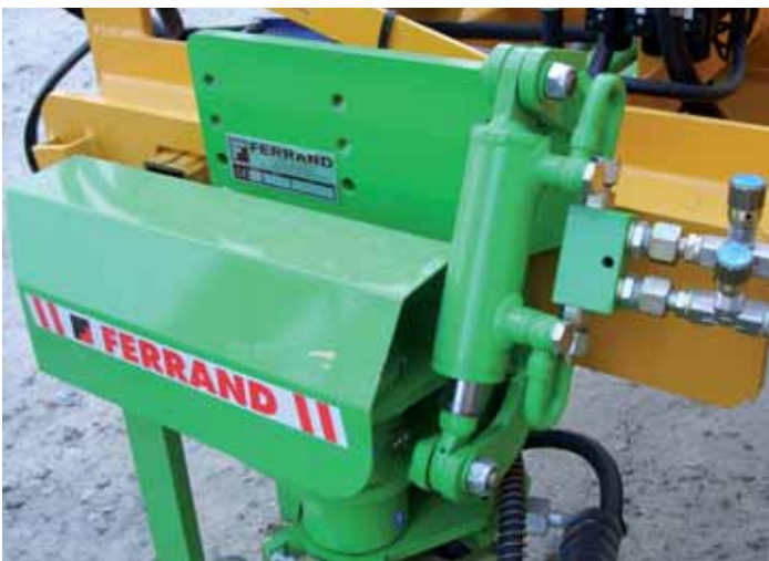
Vérin de contrôle du dévers Ferrand
