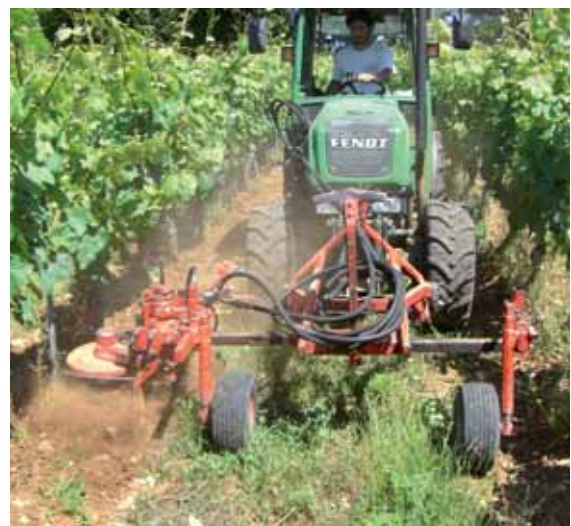
Montage à l'avant du Starmatic de Boisselet
