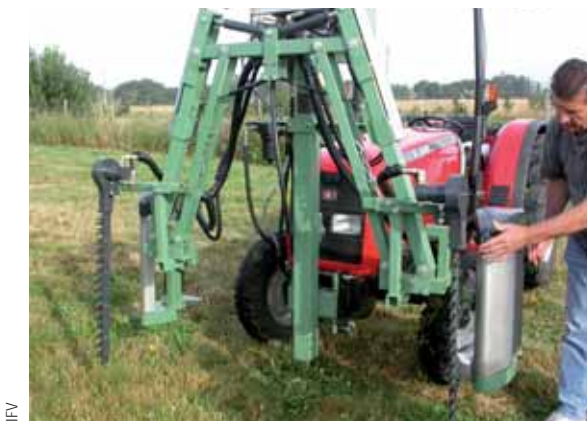
Effeuilleuse Magnetto : rouleaux et barre de coupe
