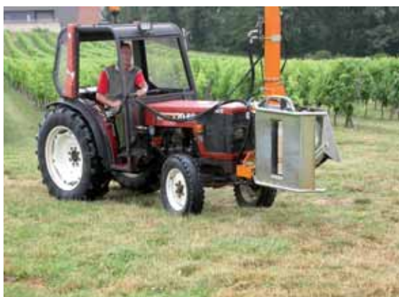
Effeilleuse à rouleaux Binger Seilzug et détail de son mécanisme
