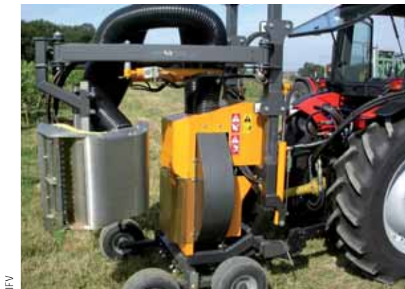
Turbine et tête d'effeuillage Grégoire
