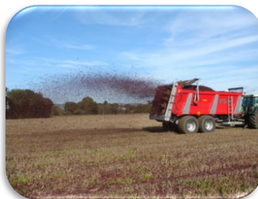
Epandage de marcs de raisins sur grande culture à l'aide d'un épandeur à hérissons horizontaux
