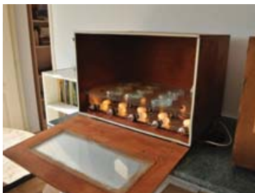
Enceinte de cristallisation
