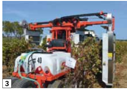
▲ Les trois appareils à panneaux récupérateurs testés sur EvaSprayViti par EcotechViti (Irrstea-IFV) : 2. Berton Arcobaleno. 3. Friuli Drift Recovery. 4. Weber NC1000 UEZ QU.
