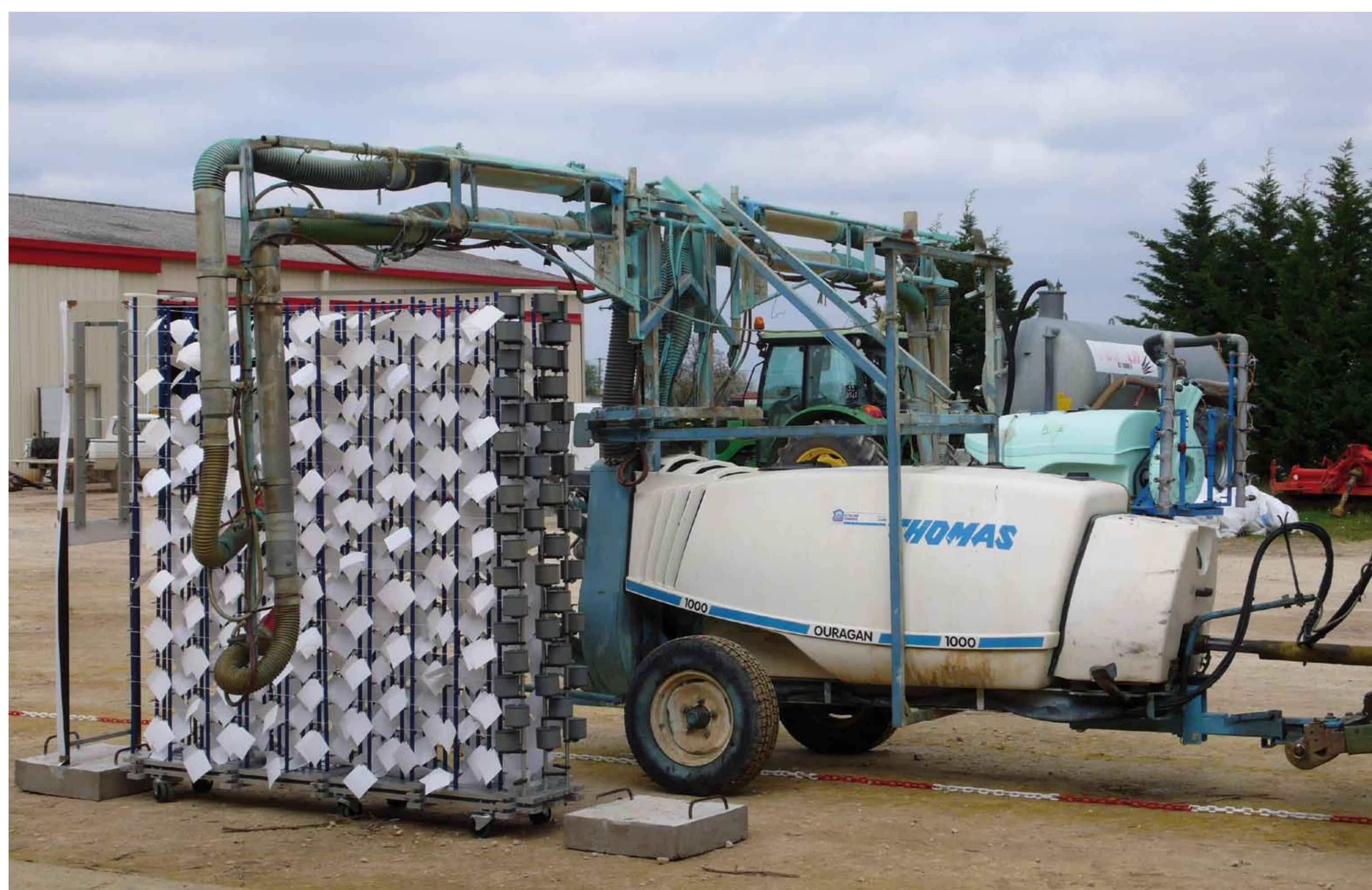
Banc de comparaison simulant un rang de vigne équipé de capteurs
